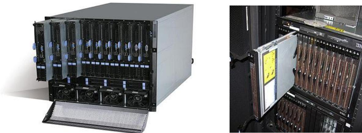
高密度伺服器 (High-Density Server) 係因應資料中心的高密度配置而發展出來的新型伺服器，比較有名的產品是 2008 年 IBM 推出屬於 Intel-based 的 x86 架構的高密度伺服器 System x iDataPlex，該款半深式雙插槽伺服器，在 2U 的機箱中可以承載 2 台伺服器，但在 2U 的機櫃空間卻可以放進 2 個 2U 機箱，平均每 1U 高度的密度同樣可以承載 2 台伺服器。
